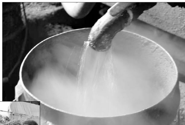
▲麻酢液は麻炭を製造する際の副産物。600リットルのヘンプの茎から16リットルの麻酢液を採取した
