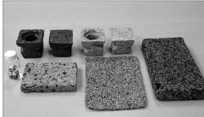
札幌の民間業者が製造したヘンプの茎を使ったバイオエタノールや土木資材、内装パネルなどの試作品。原料供給が絶たれ困っている
