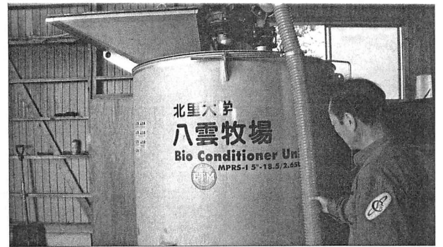
魚のアラなどを乳酸発酵させるプラントを導入し、肥料や土壌改良材に活用する試験も行なっている
