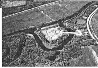
河口から8.5km上流の旧河川を掘削し、02年から蛇行復元試験が行なわれている。上が蛇行復元前の航空写真で、右の写真が復元後
